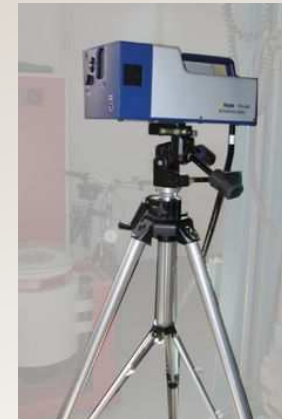
Modale Analyse mit dem Scanning Vibrometer
