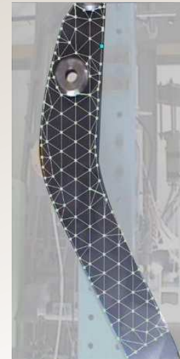
Modale Analyse mit dem Scanning Vibrometer
